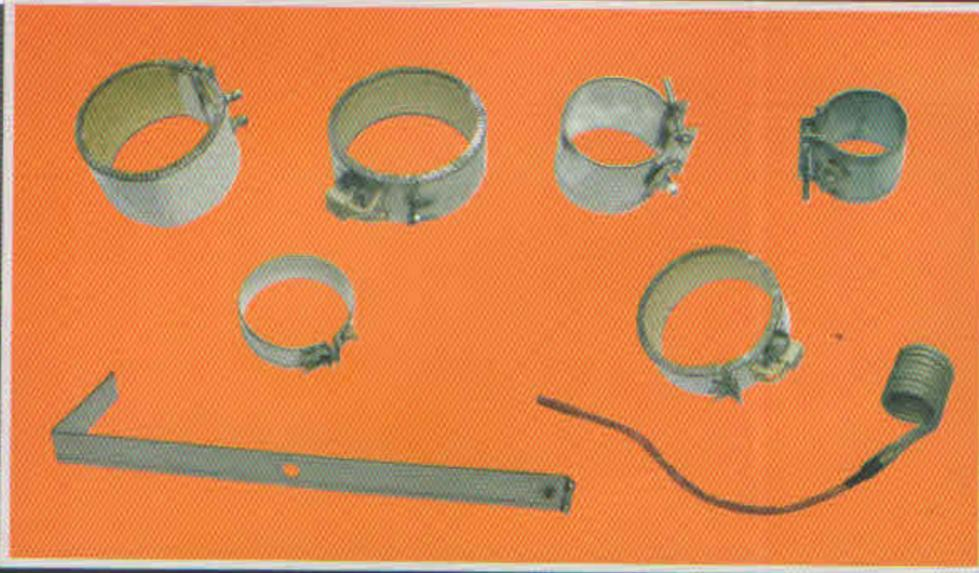
Podem ser em forma de coleira ou retas. Estas resistências são fabricadas em mica ou porcelana refratária e revestidas em aço inox ou chapas minimizadas. São mais comumente usadas em injeção de plásticos, moldes e máquinas extrusoras.
